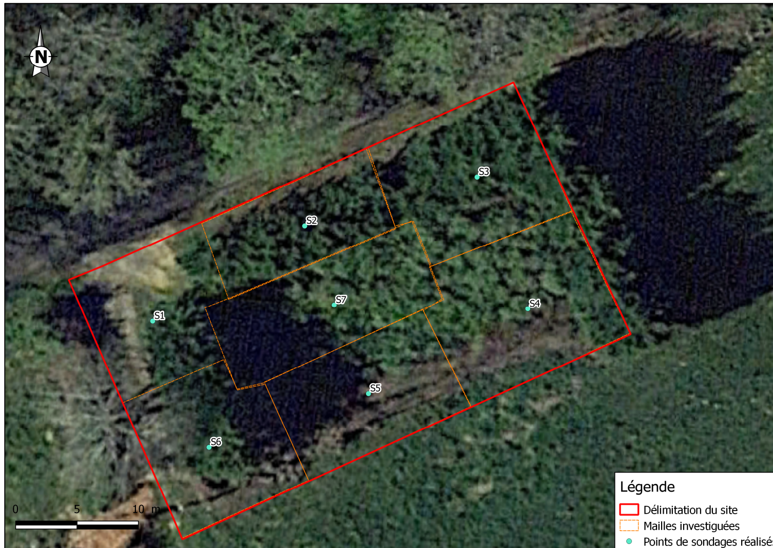
Localisation des points de sondage du diagnostic complémentaire avant travaux
